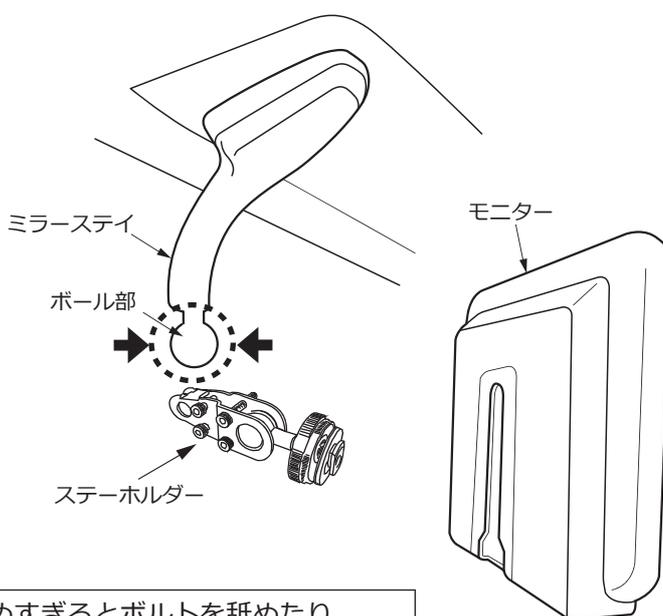
ステーホルダーの締めすぎにご注意ください。締めすぎるとボルトを舐めたり、プレート部の曲がりに繋がります。モニター固定後、ケーブル配線などはタイラップなどを用い固定してください。
