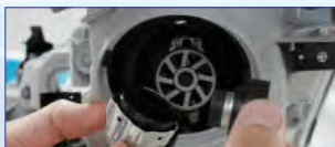
③バラストコネクタとLEDバルブのソケットを接続する。
