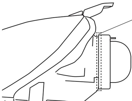
脱落や水が浸入しないようにゴムカバーとヘッドランプの境目に防水処理を行ってください。
