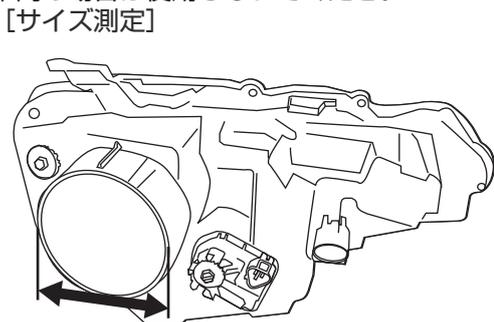
ヘッドランプ矢印の部分の外径測定を行ってください。
