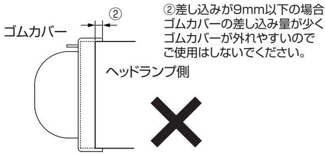
②差し込みが9mm以下の場合ゴムカバーの差し込み量が少くゴムカバーが外れやすいのでご使用はしないでください。
