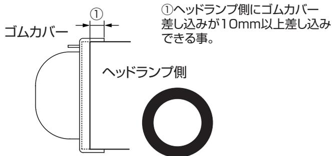
①ヘッドランプ側にゴムカバー差し込みが10mm以上差し込みできる事。
