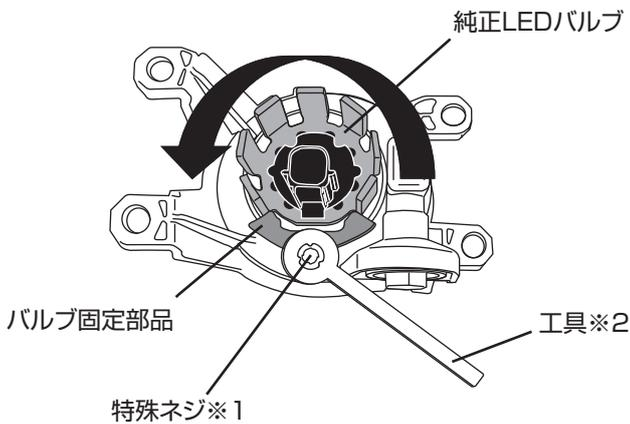
※2.工具をラジオペンチ等で、持ち手形状を曲げると作業がしやすくなります。
