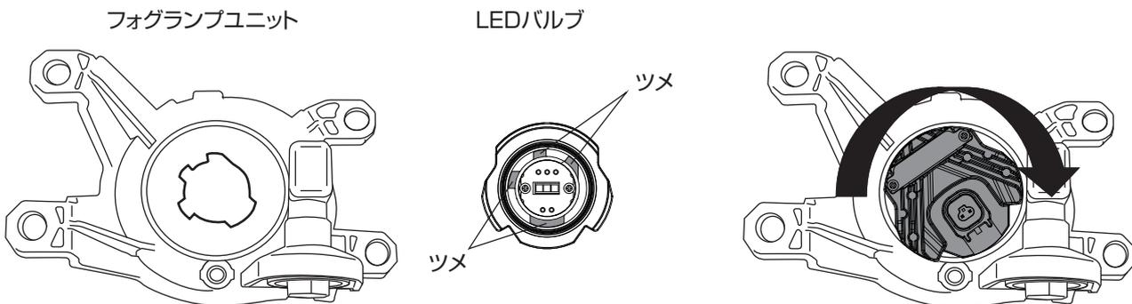
2. 取外したバルブ固定部品、特殊ネジを、付属の工具を使い取付けてください。
