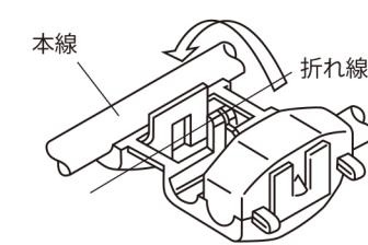
① 照明器の配線を図のストップに突きあて、矢印の方にたたみ返し、プライヤでラッチがかむまで締め付けます。
