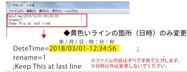
(5) microSDHC カードを取り出します。時刻補正した microSDHC カードを本器に挿入。エンジンをかけて録画作動を確認したら時刻補正は終了です。
