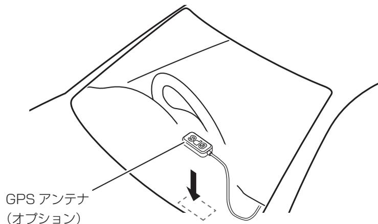
※GPS アンテナは受信面ができるだけ水平になるように取り付けてください。
