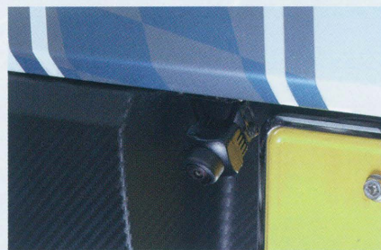
バックカメラは純正にも後付けにも対応。特殊な端子でも、市販の変換アダプタでRCA端子に変換できれば取り付けられる。
