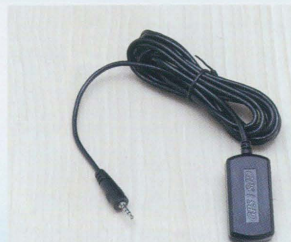
オプションで「GPSセンサー」（実勢価格：4200円前後）も用意。映像データに位置情報を追加でき、内蔵時計も自動修正してくれる。
