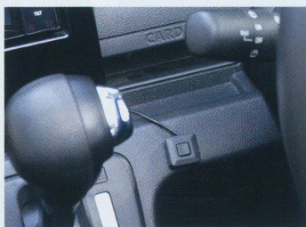
残しておきたいシーンで付属スイッチを押すと、押した前後の計3ファイルを上書き禁止でマニュアル録画。映像データは別のフォルダに収納される。
