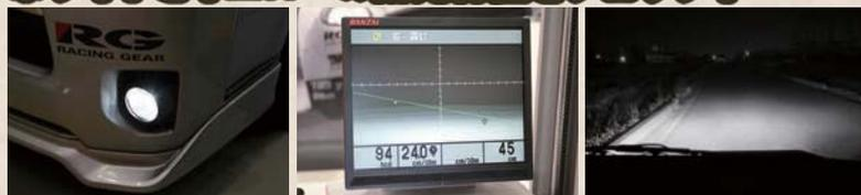
ホワイト光によるヘッドライトテストの測定結果と室内からの視認性をチェック。カットラインは少し下方で、左右ワイドに照らしていることが分かる。
