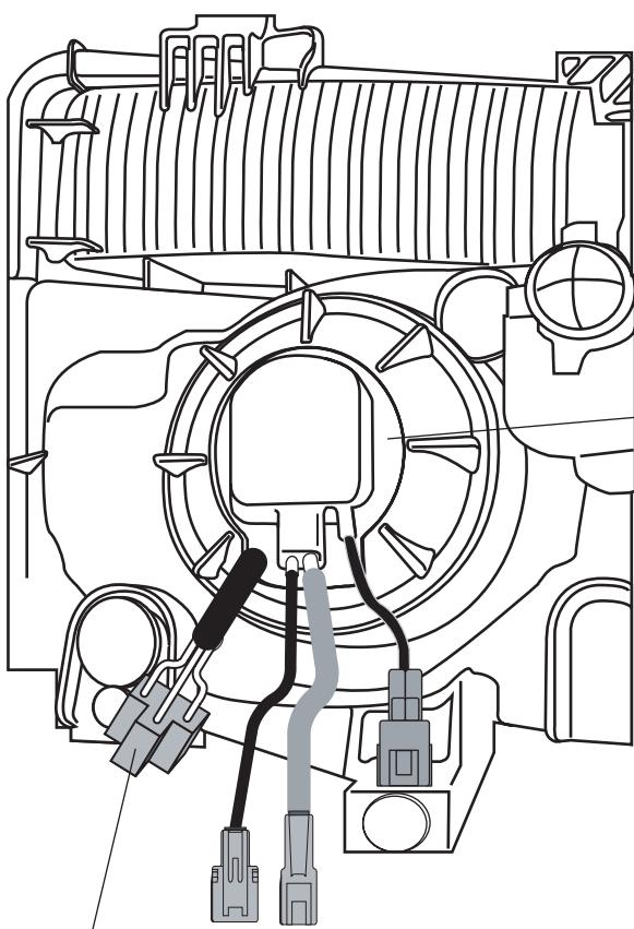
2. 左図の様に、樹脂防水カバーに、バルブ後方が干渉しないように穴あけ加工を行い固定してください。バルブから出ている配線類や車両側電源コネクターを図のように出して下さい。
