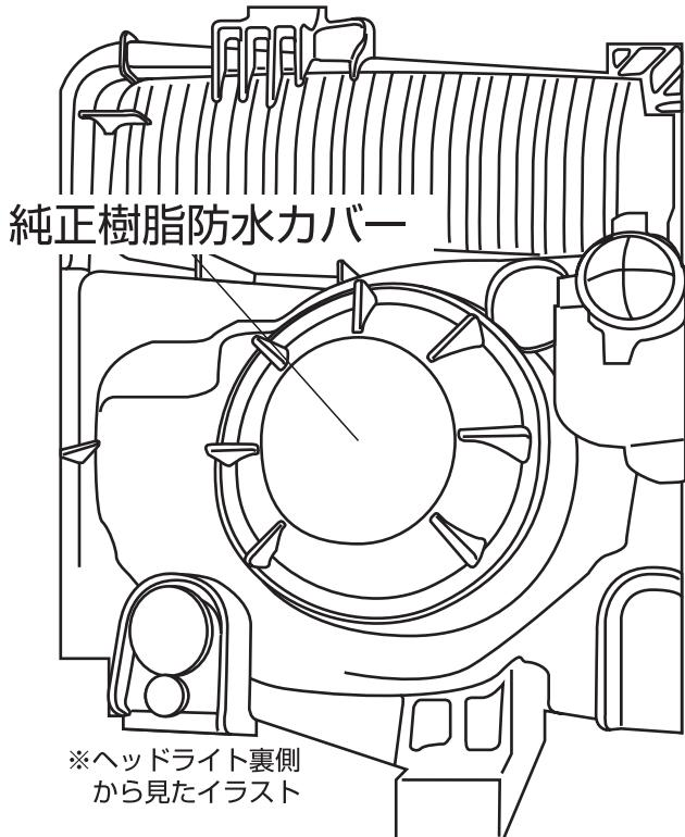
1. 左図の様に、ヘッドライト裏に純正樹脂防水カバーが付いている車両は、バルブ後方スペースを確保出来ない場合があります。（装着に必要な有効スペースは下図を参照）このような場合、HIDを装着するには、樹脂防水カバーに加工を行なう必要があります。
