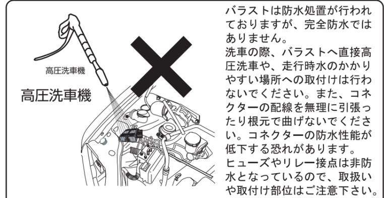
バラストは防水処置が行われておりますが、完全防水ではありません。洗車の際、バラストへ直接高圧洗車や、走行時水のかかりやすい場所への取付けは行わないでください。また、コネクタの配線を無理に引っ張ったり根元で曲げないでください。コネクタの防水性能が低下する恐れがあります。ヒューズやリレー接点は非防水となっているので、取扱いや取付け部位はご注意ください。
